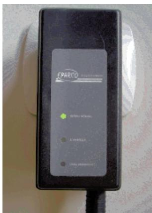
Le boîtier installé dans l'habitation (photo) est relié au DNB par un simple câble électrique. Il comporte un voyant vert, qui reste allumé tant que la lumière passe. Dès que les boues atteignent le niveau prévu, c'est le voyant rouge qui s'allume. La fosse doit alors être vidangée dans un délai raisonnable, qu'Éparco évalue à trois mois.
