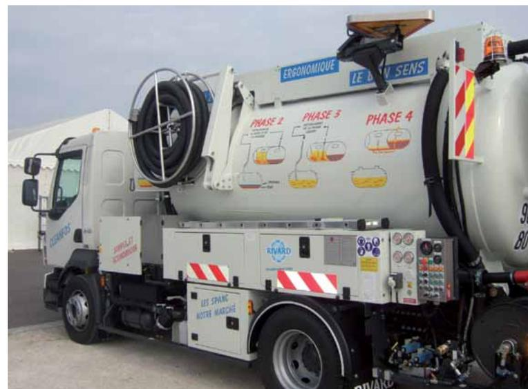
Pour éviter de transporter l'eau jusqu'à la station d'épuration, Rivard propose un système qui amène la station jusqu'à la fosse.
