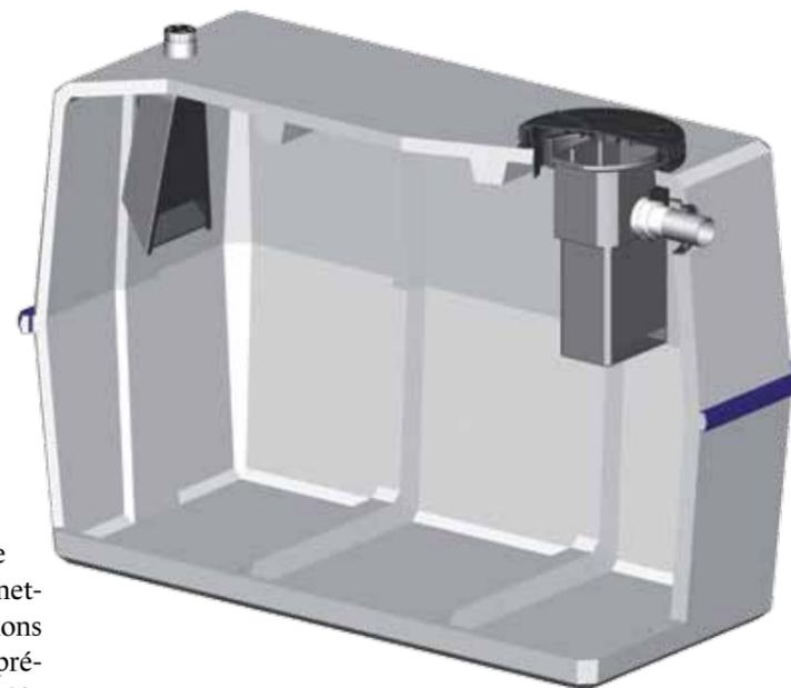
nouveau diffuseur d'entrée possède des performances hydrauliques améliorées grâce à une forme évasée qui permet de ralentir et d'apaiser l'effluent pour éviter les éventuelles turbulences dans la fosse. ●
