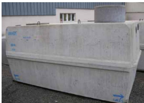
**L**A FOSSE toutes eaux Eurofos est disponible avec des volumes de 3 m<sup>3</sup>, 4 m<sup>3</sup>, 5 m<sup>3</sup> et 7 m<sup>3</sup>. Elle est fabriquée en béton renforcé avec le préfiltre intégré. Ce préfiltre composé de pouzzolane est contenu dans un panier amovible en plastique.
