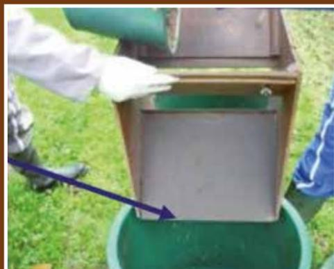
Le quartage nécessite de prélever des échantillons de sable dans différentes parties du filtre, puis de les mélanger pour obtenir un échantillon moyen représentatif du filtre à sable. L'usage d'un échantillonneur permet enfin de réduire le volume de cet échantillon sans affecter sa représentativité.
